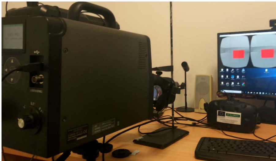
Figura 3.3: Montaje experimental utilizado para la caracterización cromática del dispositivo Oculus Rift.
