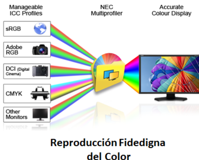
Figura 1.7: Esquema de funcionamiento de un sistema gestión del color. Fuente: http://www.aulapc.es/
