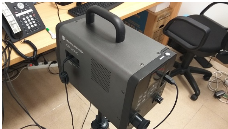
Figura 3.5: Espectrorradiómetro utilizado durante las mediciones.
