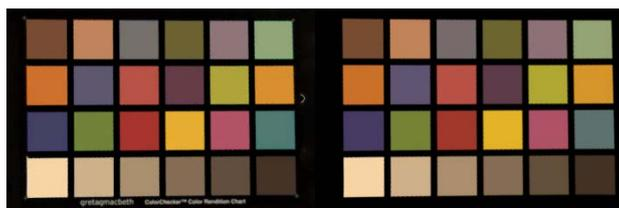
**Figura 5:** Color Checker con cambio de fuente luminosa TL840 (izqda) y con cálculo de textura hiperespectral (drcha.)
