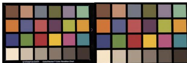
**Figura 6:** Color Checker con cambio de fuente luminosa simulador D50 (izqda) y con cálculo de textura hiperespectral (drcha.)
