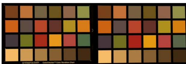
**Figura 7:** Color Checker con cambio de fuente luminosa simulador A (izqda) y con cálculo de textura hiperespectral (drcha.)
