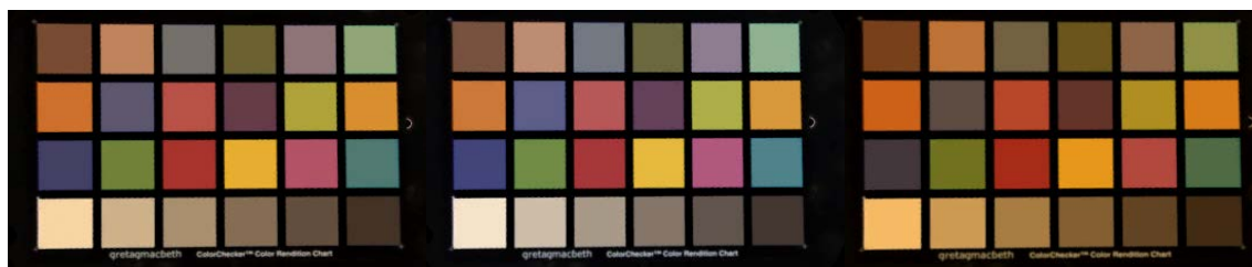
Figura 7: Efecto del cambio de fuente luminosa sobre el Color Checker para la fuente luminosa TL84 (izqda), simulador D50 (centro) y simulador A (dcha).
