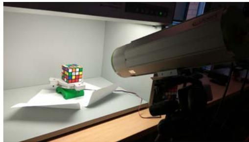
**Figura 1:** Escenario utilizado para la reconstrucción del objeto 3D.
