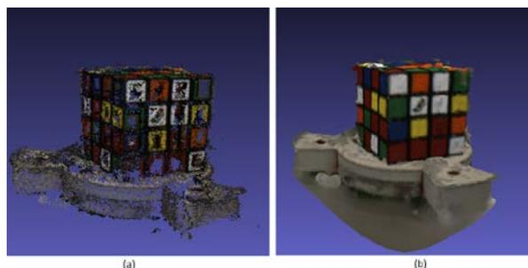
**Figura 3:** Nube de puntos (a) y creación de mallas con algoritmo de Poisson (b) para la cámara RGB.
